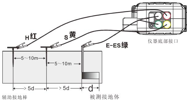
图 8.4-2 三线法测量接线示意图
