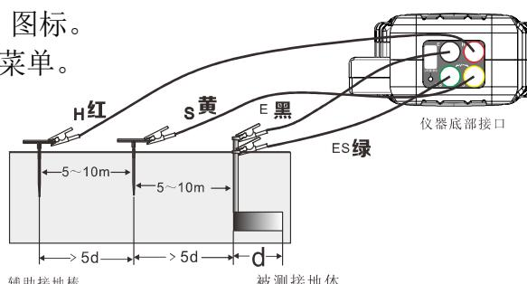
图 8.4-1 四线法测试接线示意图
