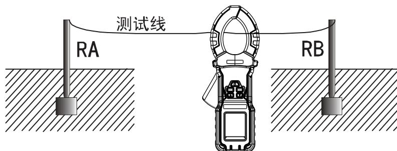
由于钳表所测的阻值是两个接地电阻和测试线阻值的串联值。
